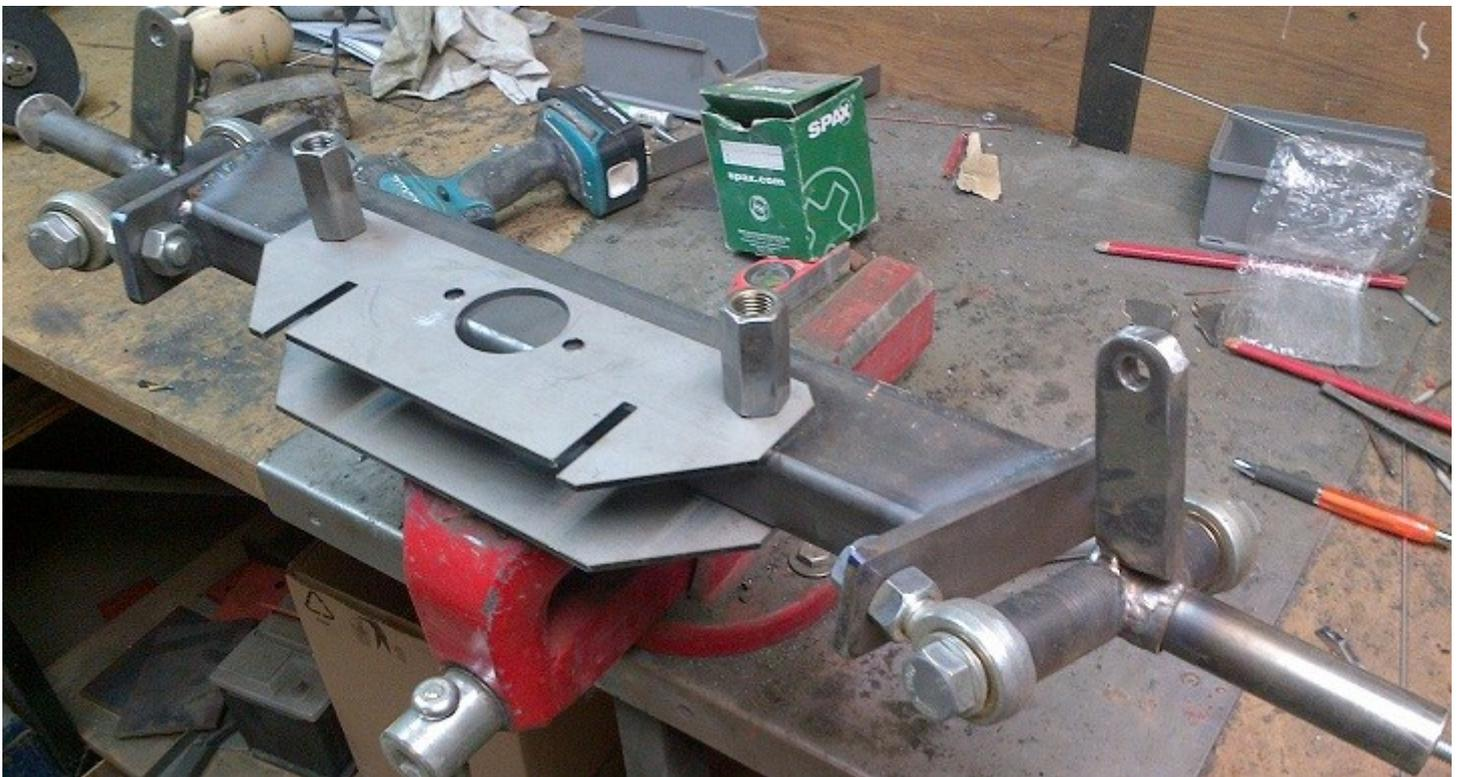
Wir beginnen in diesem Beispiel mit der Vorderachse. Diese darf nicht gefedert sein. In diesem Fall besteht der Grundkörper aus einem 3mm Hohlprofil. Auf beiden Seiten wird ein Flachstahl schräg angeschweisst. Dieser nimmt die Gelenklager auf, in der der Achsschenkel drehbar gelagert ist. Hier kann ich wartungsfreie Gelenklager der Grösse M16 empfehlen. Das Schweiessen der Vorderachse und vor allem der Achsschenkel, sollte
