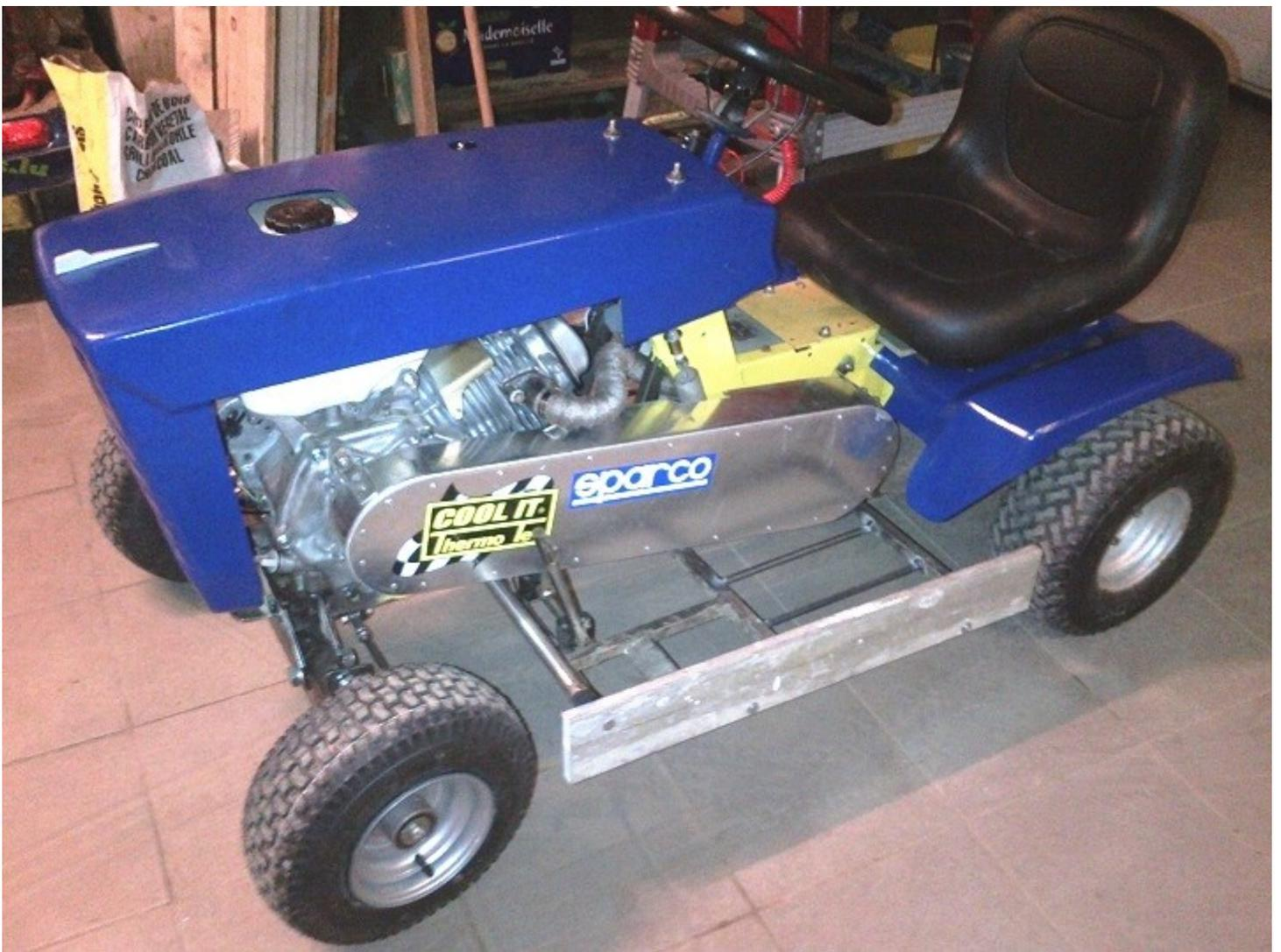
Mit etwas Farbe sieht das schon Ganze schon sportlicher aus. Es wurde noch ein Seitenschutz installiert, eine Aluschiene aus dem Baumarkt. Ausserdem ist der Not-aus zu erkennen. Dieser stoppt den Motor, falls der Fahrer das Gefährt ungewollt verlässt.
