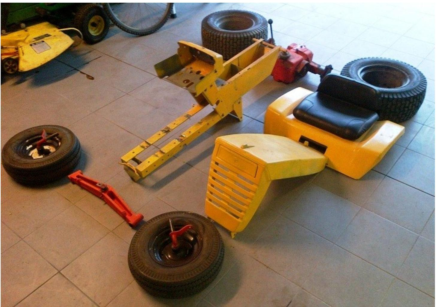
Dann wird der Traktor zerlegt. Die Reifen sind in der Regel zu gross, das Getriebe wird nicht mehr benötigt und die Vorderachse wird neu konstruiert. Was dann noch bleibt ist recht überschaubar.
