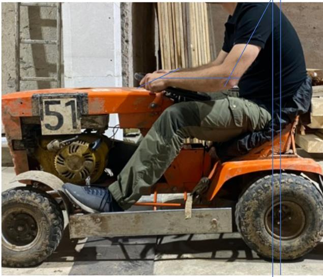
Der Schwerpunkt des Fahrers liegt knapp vor der Hinterachse. Die aktuelle Position des Lenkrades erlaubt keine Verschiebung des Fahrersitzes nach vorne.
