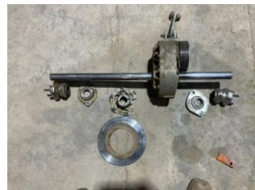
Abschließend kann man sagen, dass die Hinterachse (Getriebe, Riemenscheibe, Achslager, Felgenaufnahme) bis auf die Bremsscheibe bis dato keine nennenswerte Abnutzungserscheinungen aufweist.
